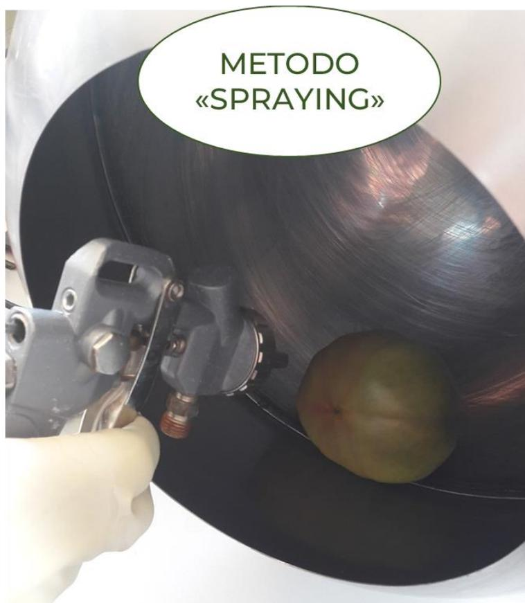
Una volta che il prodotto è uniformemente distribuito si avvia il processo di essiccazione, a medie temperature e ad alta ventilazione, per la rimozione del solvente del coating facendo sì che si formi
