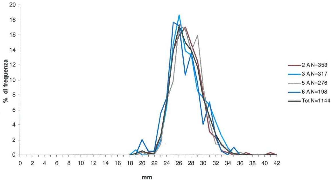
**Fig. 35 - Distribuzione di frequenza per taglia per singola cala della frazione del popolamento di vongole ritenuta dalla piastra del vibro-vaglio con fori da 19 mm di diametro. Termoli.**
