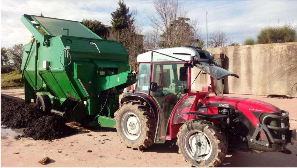
**Figura 1: Impianto COMEF in opera, prova di spandimento *compost***
