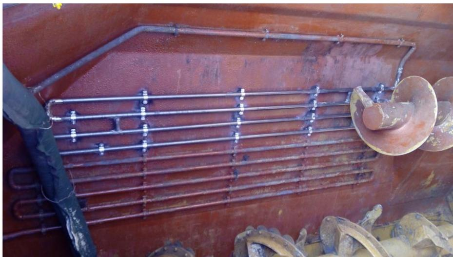
**Figura 11: Intervento per aumentare la superficie di scambio della serpentina di riscaldamento**
