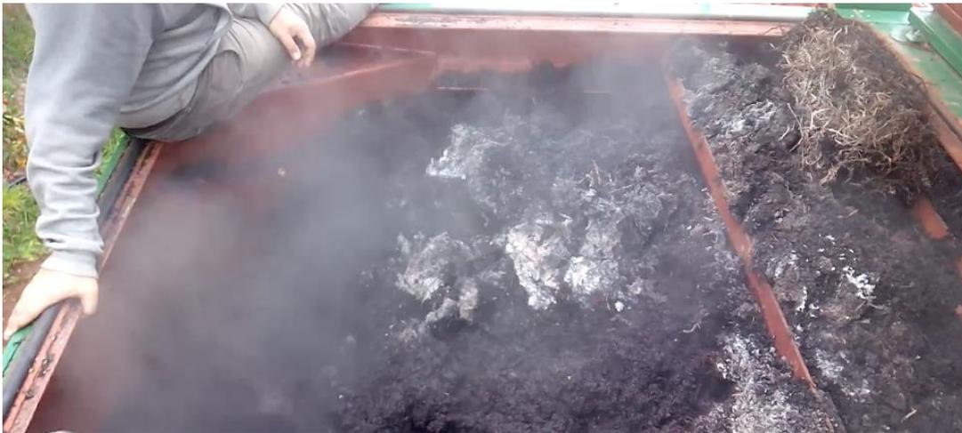
**Figura 2: Stato del substrato all'interno del reattore in condizioni aerobiche**
