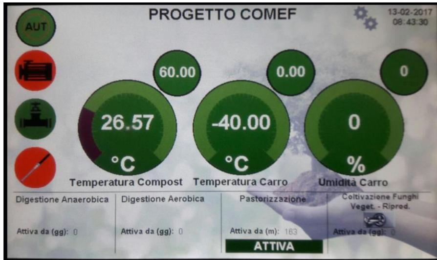
**Figura 16: Pannello di controllo impianto COMEF (nella fase attiva la sonda di temperatura e umidità del carro è disattivata e i valori visualizzati sono rispettivamente  $-40\_C$  e  $0\%$ )**
