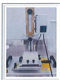
Figura 8. Sistema modello ad Ac per mini-formaggi, adattato a piastre a 96 pozzetti per la produzione di formaggi con sistema di riscaldamento e rottura della cagliata manuale. Il piano si muove orizzontalmente e verticalmente per simulare le fasi di agitazione e cottura.
