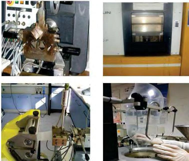
**Figura 13:** Tecnologie di lavorazione classiche dei polimeri 1) melt mixing, 2) compression molding, 3) cast extrusion, 4) film blowing
